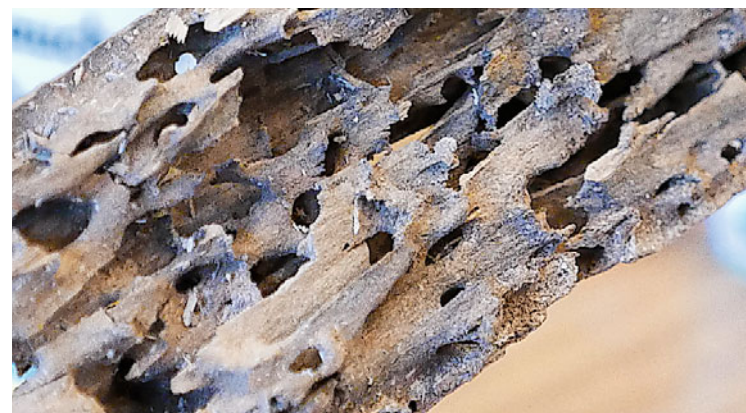
Viel Erfahrung ist notwendig, um das Zusammenwirken mehrerer Schädlings zu erkennen: Ameisen haben in diesem Holz die Larvenbohrgänge des Hausbocks ausgeräumt.
